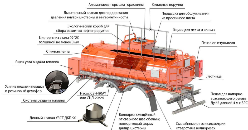
Рисунок Н.1 – Конструкция автотопливозаправщика
